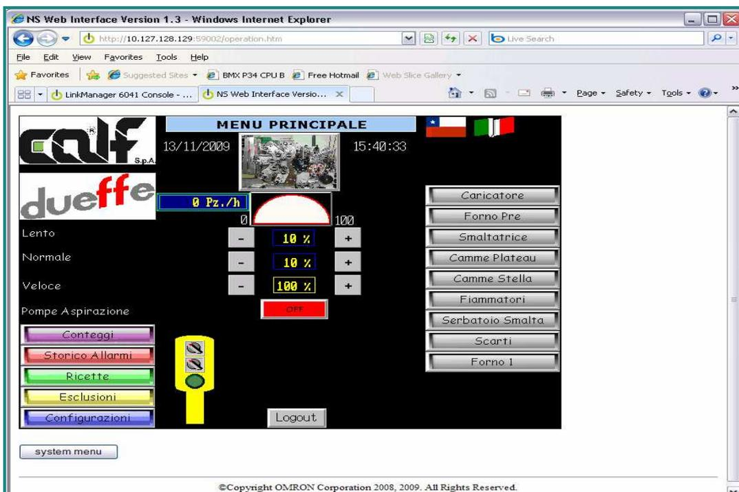
Figura 7 – Schermata dell'interfaccia Web HMI Omron
